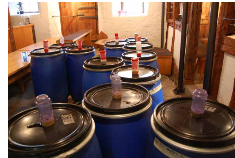
Fruchtzucker wird zu Alkohol: In solchen Fässern werden die Erdbeeren während rund zweier Wochen vergoren.
